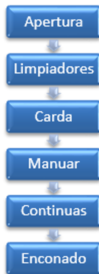
Figura 10. Diagrama de flujo de producción de hilo open-end
