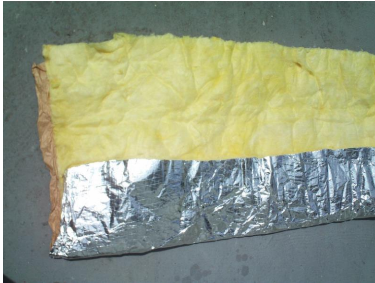
Figura 15. Diseño con tapas forradas de lana mineral y fibra de vidrio
