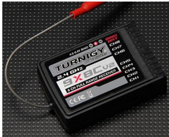
Fuente: Volando en el cielo. *Modulo receptor Turnigy 9x8c – v2 8 channel receiver.*
