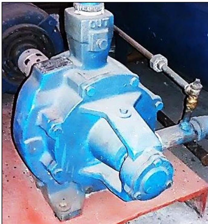
Figura 19. Bomba de alimentación de agua
