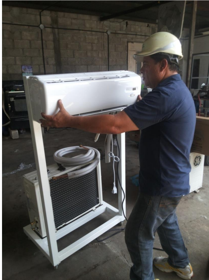
Figura 39. Estructura y aire acondicionado Minisplit de 12 000, BTU/hora
