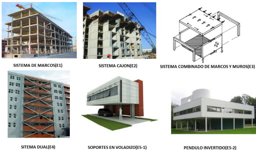
Figura 4. Ejemplos de los sistemas estructurales
