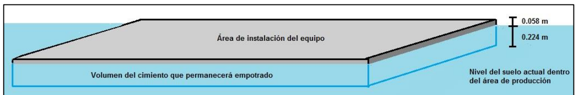
Figura 36. Nivel del cimiento
