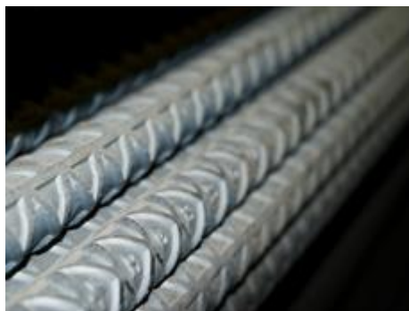
Figura 37. Barras de acero corrugado
