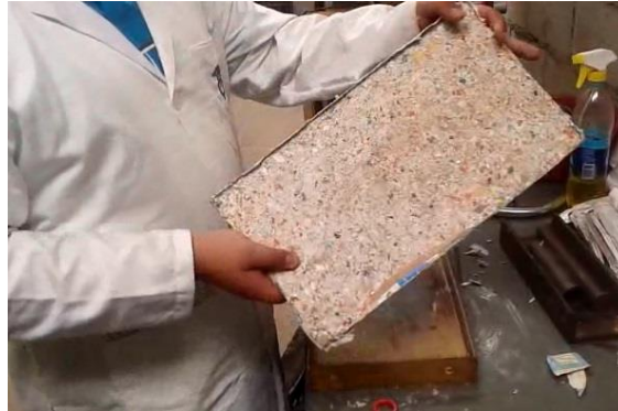
Figura 20. Tetrapanel CII recién fabricado
