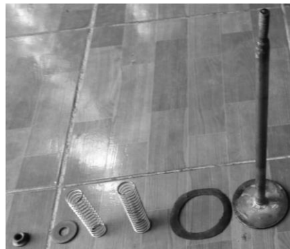
Figura 15. Émbolo fabricado para el ariete hidráulico
