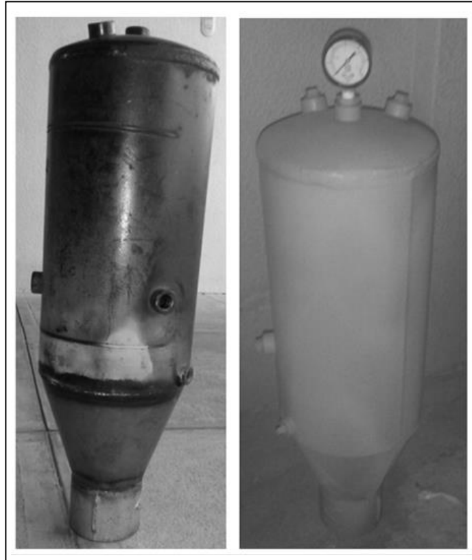
Figura 17. Cámara de aire fabricada para el ariete hidráulico
