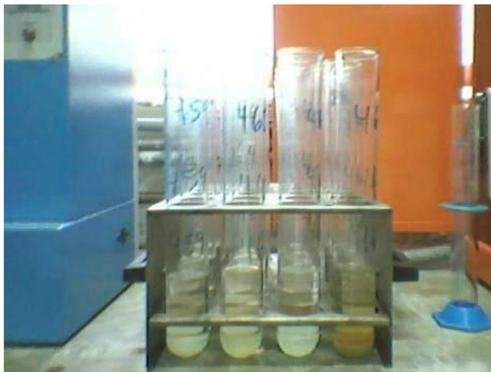
**Figura 9A. Determinación de Proteína Cruda o nitrógeno total (macro kjendahl).**
