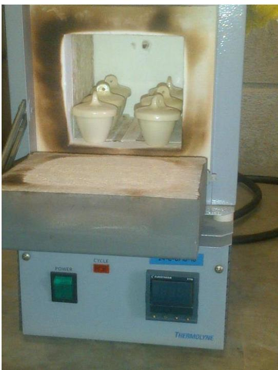
**Figura 14A. Determinación de Cenizas o Minerales Totales**
