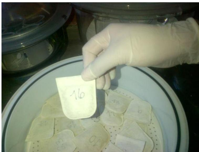
**Figura 12A. Determinación de la FAD por el método Van Soest.**
