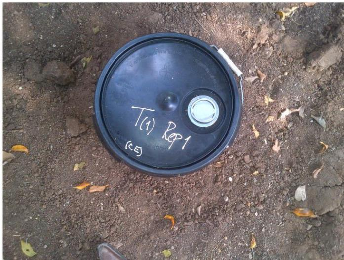
**Figura 5A. Sellado, identificación y semientierro de los microsilos.**
