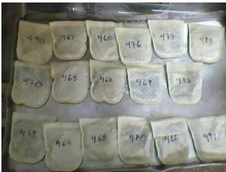
**Figura 11A. Determinación de la FND por el método Van Soest.**
