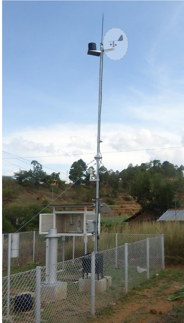
Figura 26. Anemógrafo estación telemétrica satelital
