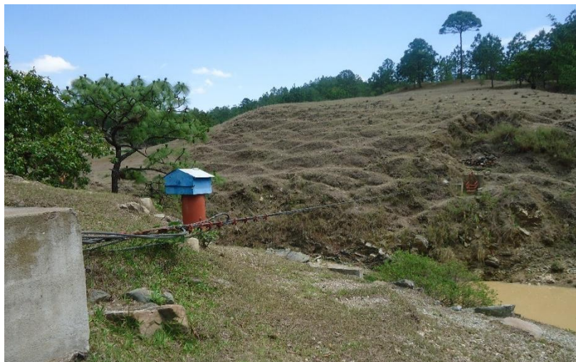
Figura 30. Limnógrafo y cable vía para aforo aéreo
