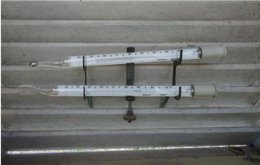
Figura 22. Termómetro de máxima y mínima
