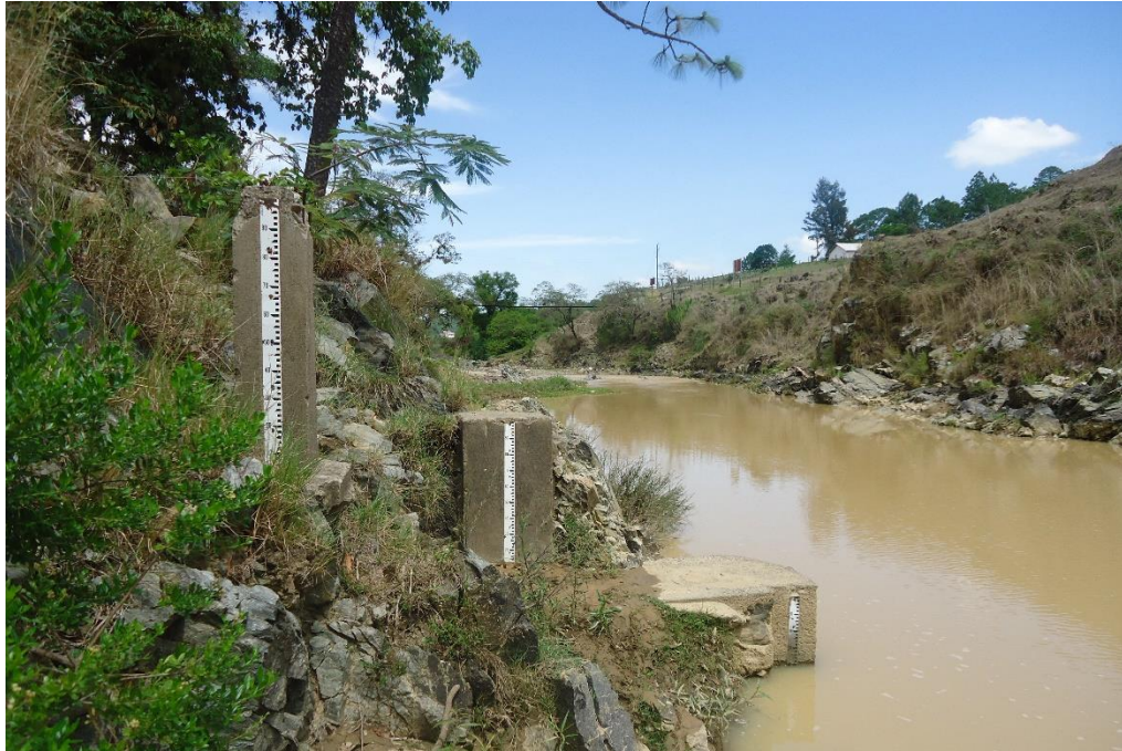
Figura 28. Limnómetros de escala graduada
