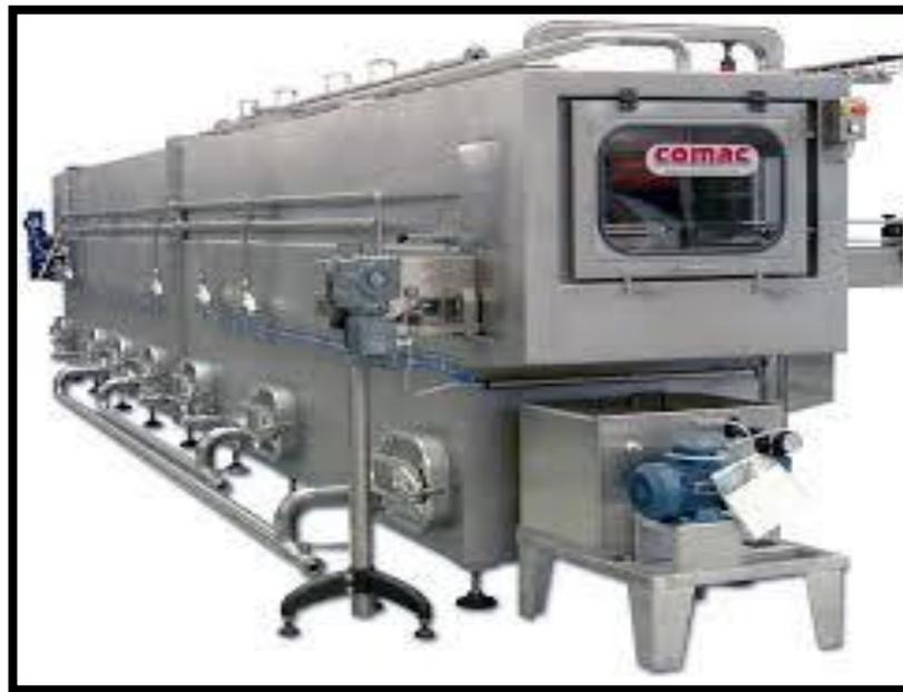
Fuente: *Máquina pasteurizadora*. <http://www.comacgroup.com/beverage-canning-machine/tunnel-pasteurizing-machine>. Consulta: junio de 2015.
