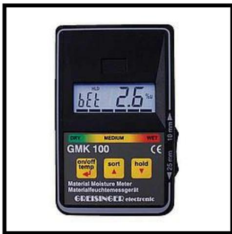
Medidor de humedad absoluta de material capacitivo para medir y valorar en madera, hormigón, pavimento, enlucidos, etc. / sin
