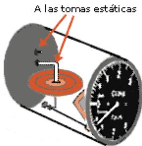
Fig.2.4.2 - Modelo de variómetro.
