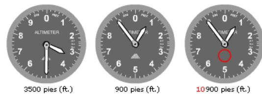
Fig.2.3.3 - Lectura del altímetro de dos agujas.
