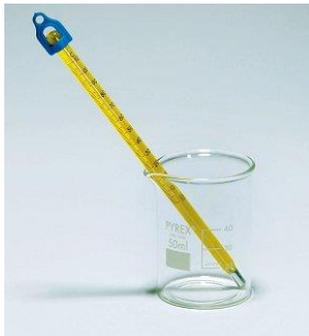
Imagen No 6. Termómetro de mercurio. Fuente: TP Laboratorio químico
