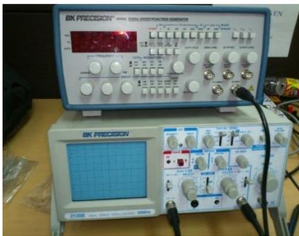
Se muestra un osciloscopio, el cual sirve para ver la longitud de onda, tipo de señal, voltaje, amperaje y básicamente para todo lo concerniente para la verificación de la electricidad generada en una planta de generación fotovoltaica. Este instrumento es complejo de operar y no sirve de nada si no se tienen conocimientos de electrónica y/o electricidad.
