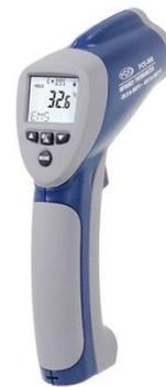
Termómetro digital laser, el cual por medio de una luz infrarroja, detecta la temperatura y envía una señal, la cual se puede observar en la pantalla, para conocer la temperatura del objeto que estamos midiendo.
