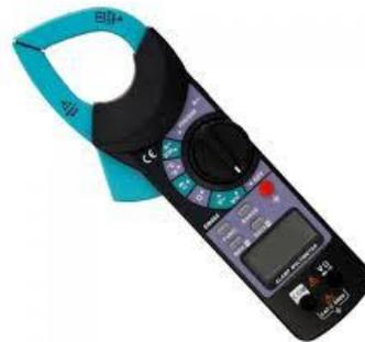
Figura 4: Amperímetro de gancho.
