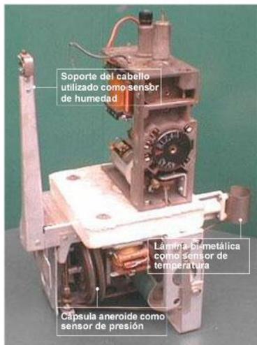
Figura No, detalle del interior de una radiosonda antiguo.
