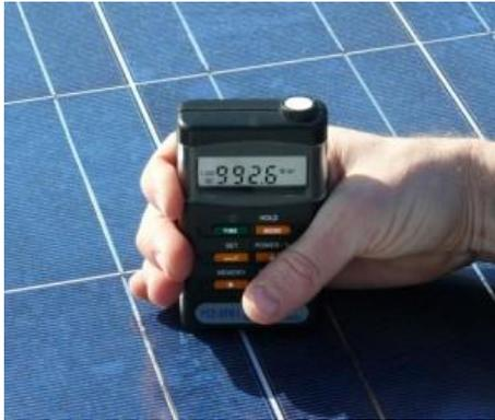
Este funciona con una célula solar de silicio monocristalina, además trae integrado un procesador que hace que toda lectura registrada sea 100% fiable con correcciones automáticas durante la medición, lo que al final da un resultado lo más ajustado a la realidad posible. El PCE-SPM 1 cuenta con una carcasa de plástico bien reforzada diseñada especialmente para su uso en exterior.
