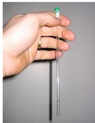
Tubo de vidrio exterior sellado con parafina, abierto en la boquilla inferior.
