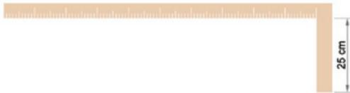
La característica de esta regla es que uno de sus lados debe medir 25 cm., mientras que por el otro lado se traza una escala en cm. para facilitar las lecturas. La medición se realiza desplazando la regla por la parte superior del tubo hasta que la parte inferior roce el chorro de agua que sale del tubo. En ese momento se lee en el lado que está sobre el tubo la distancia que alcanza el chorro y conociendo el diámetro del tubo mediante la tabla se determina el caudal.
