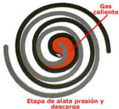
Figura 21. Descarga de gas refrigerante en un compresor scroll
