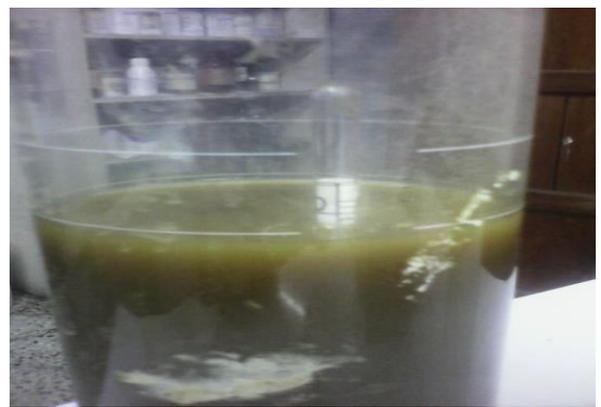
**Figura 23:** Hidrómetro suspendido en la solución.
