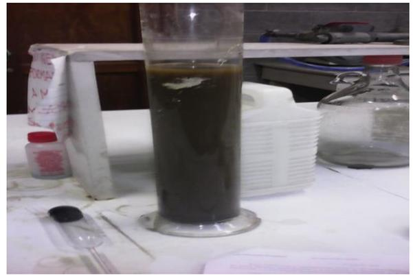
**Figura 21:** Muestra de suelo en el cilindro de sedimentación.
