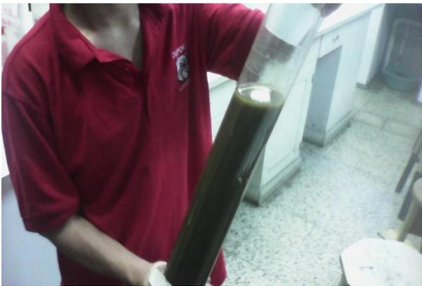
**Figura 22:** Volteo del cilindro de sedimentación.
