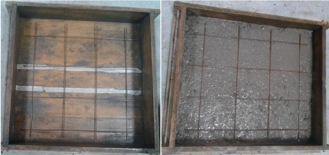
(a) Molde con electromalla antes de la fundición
