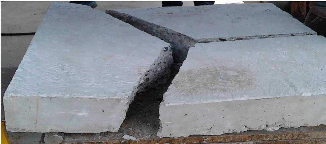
(b) Falla última del panel de concreto normal en tres partes
