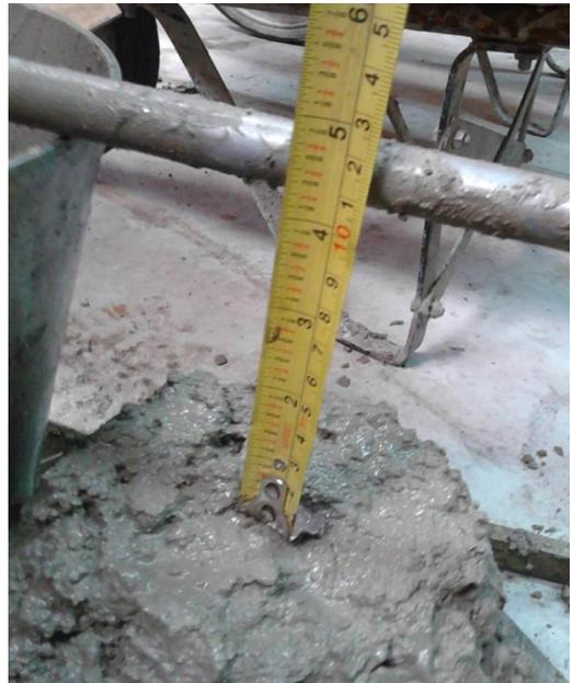
(c) prueba de consistencia del concreto
