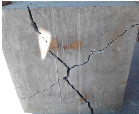
(c) Falla de losa en ensayo con fibra macrosintética
