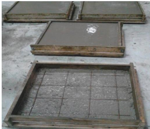
(c) Llenado final de moldes con electromalla grado 70 y concreto
