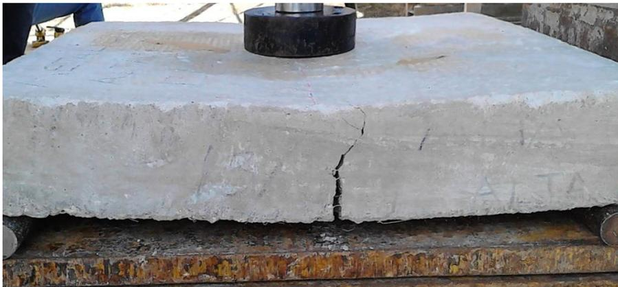
(c) Fisura sujeta por fibra metálica
