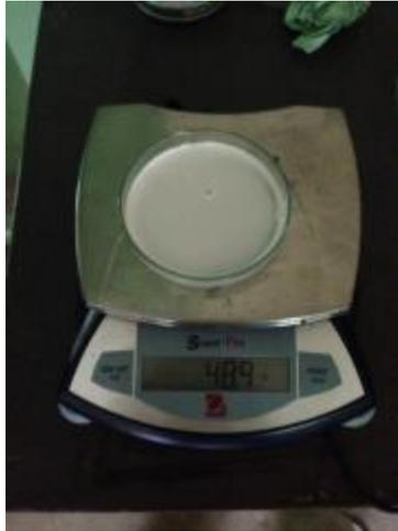
Figura 8. Peso de la caja Petri con la muestra de látex.
