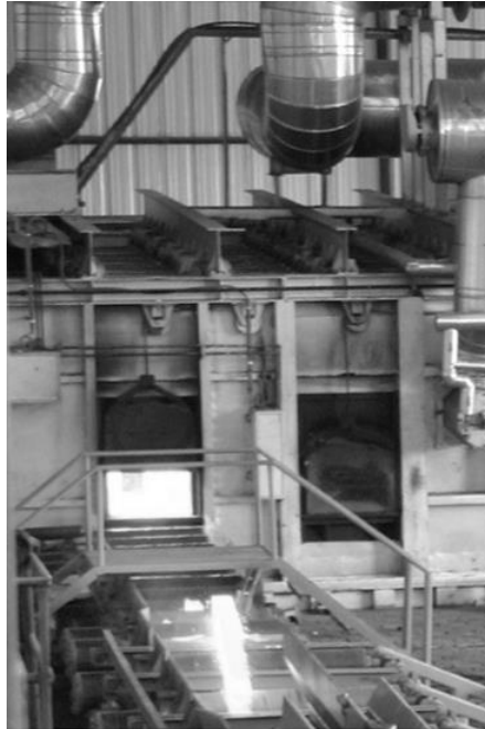
Figura 25. Salida del lingote del horno
