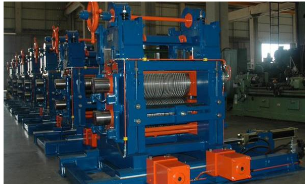
Figura 15. Castillo de laminación dúo
