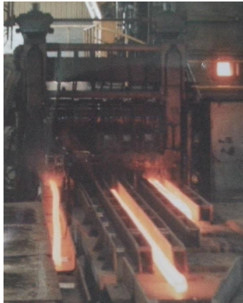
Figura 14. Castillo de laminación trío
