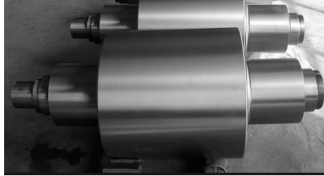
Figura 16. Rodillos de laminación nuevos
