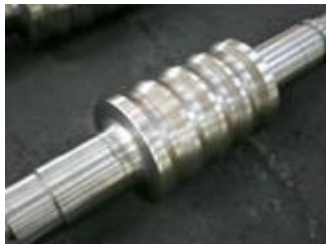
Figura 17. Rodillo de laminación calibrado
