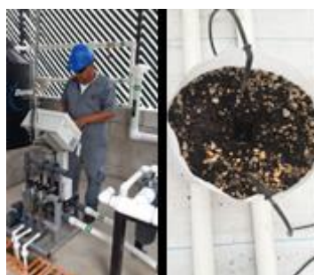
Figura 8. Operación de máquina de fertirriego y colocación de goteros en bolsa de sustrato.
