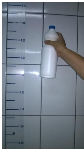
Figura 12. Forma correcta de realizar la prueba de impacto
