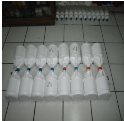
Figura 14. Forma correcta de realizar la prueba de fuga 24 horas
