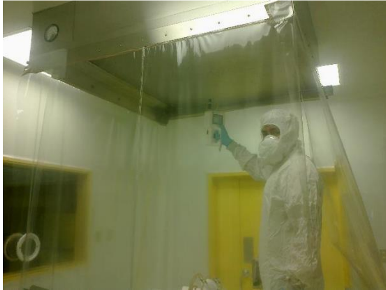
Figura 84. Medición en el centro de la campana (II)
