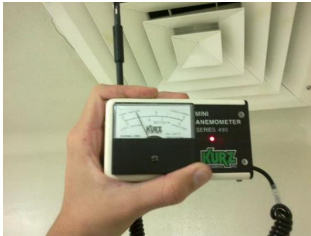
Figura 91. Medición en la rejilla de suministro (II)
