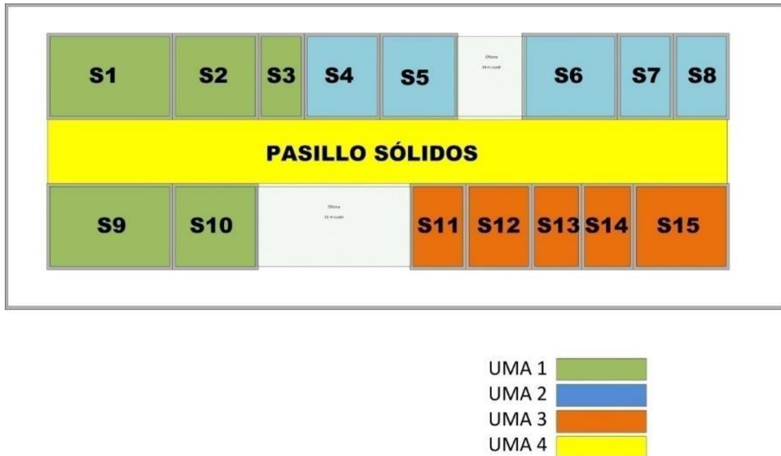
Figura 44. Distribución de ambientes del área de sólidos
