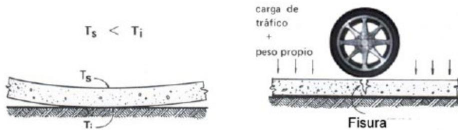
Deformación de la losa durante la noche, rotura de la losa por carga
