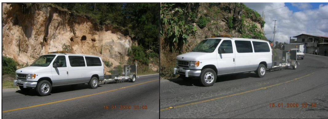
Figura 5. Medición de deflexiones para evaluar comportamiento del pavimento bajo carga
