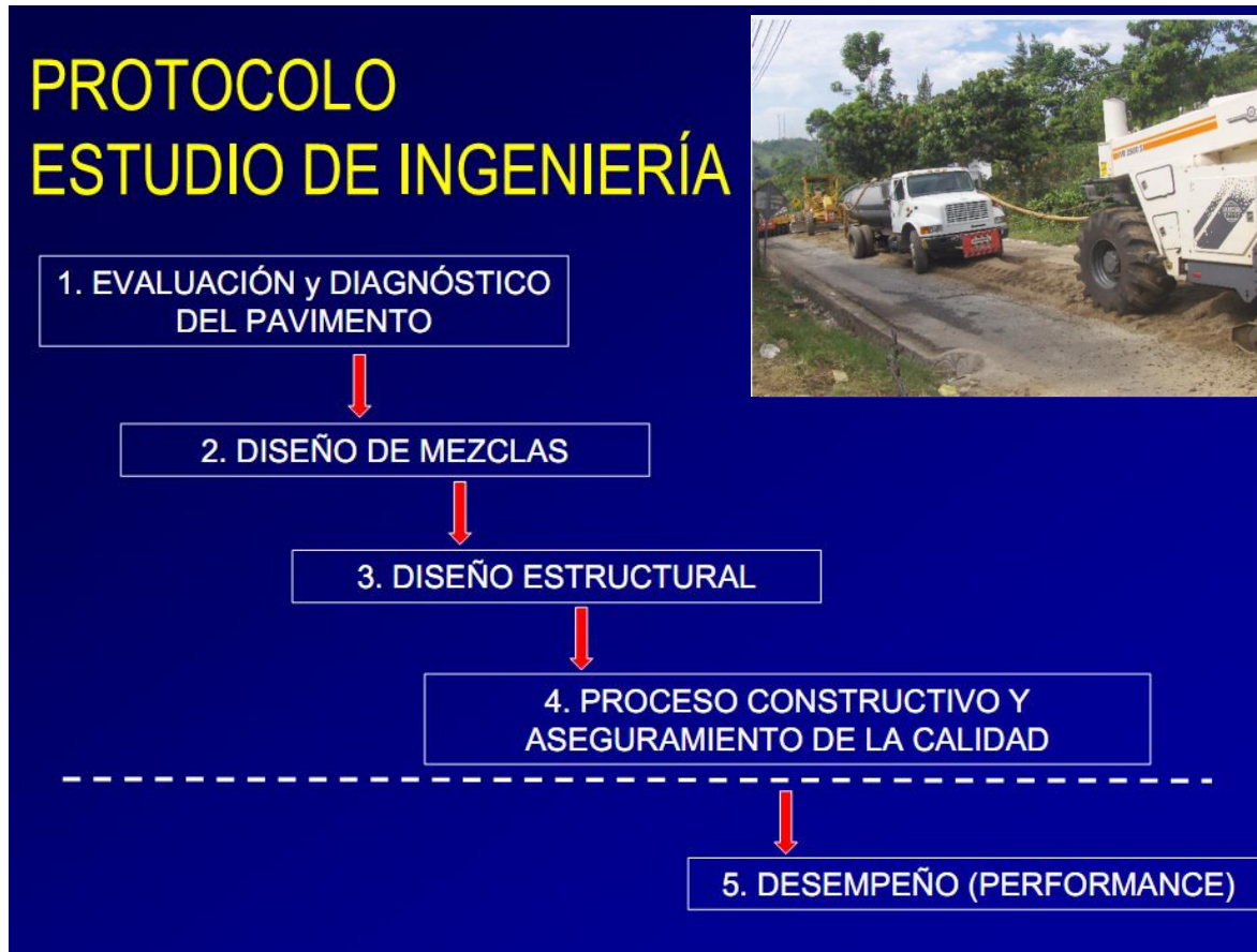
Figura 27. Protocolo del reciclado en frío in situ con asfalto espumado
