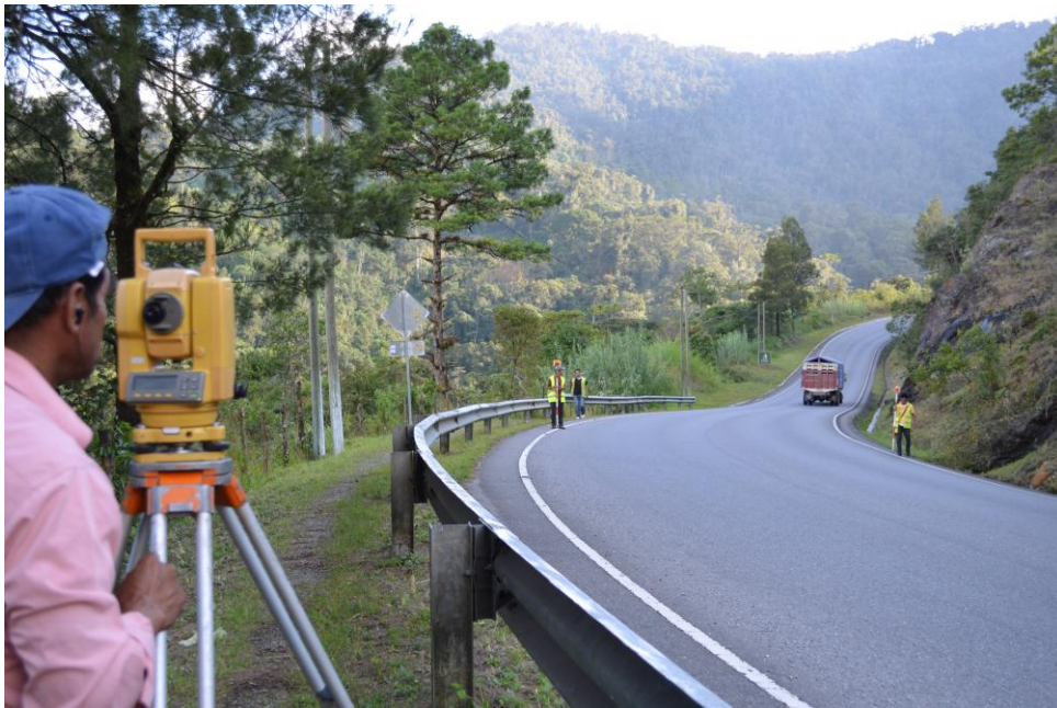
Figura 2.4. Restitución en elevación, utilizando estación total.
