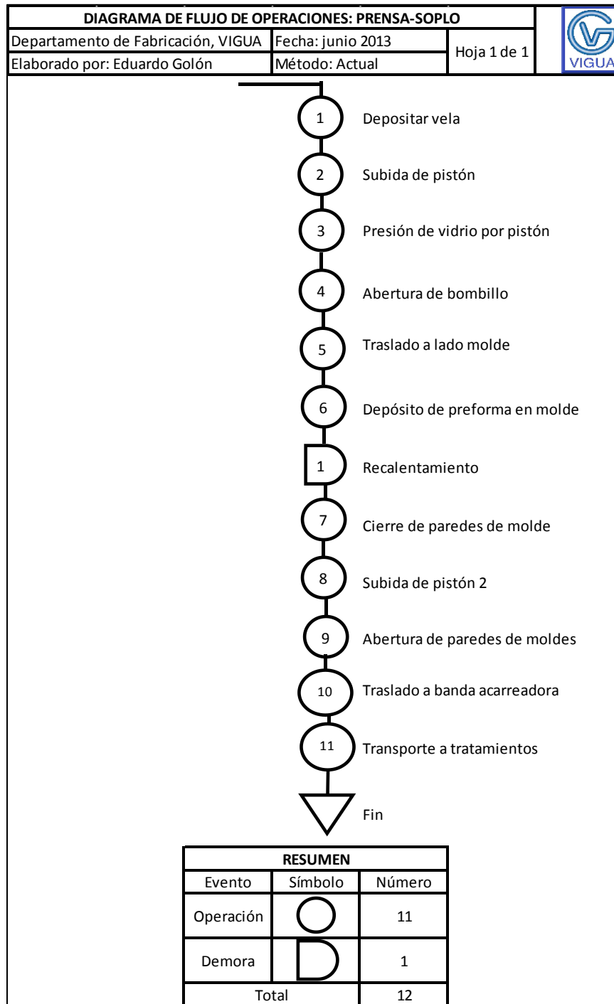
Figura 12. Diagrama de flujo de operaciones prensa-soplo
