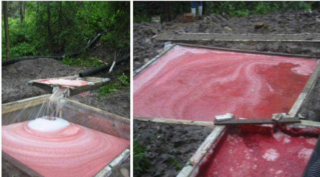
Fuente: prueba de retención de agua de proceso.
