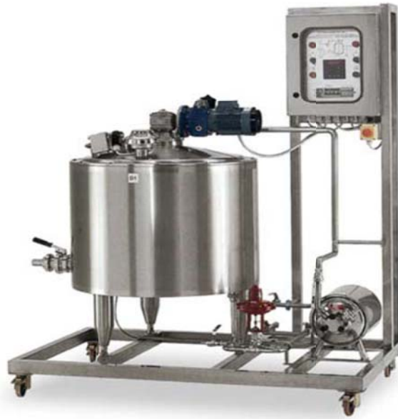
Figura 61. Fotografía de equipo multiproceso para elaboración de yogurt
