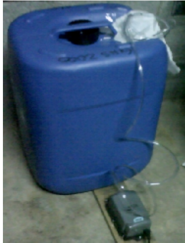
Figura 22. Instalación para fermento acético
