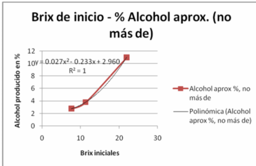
Figura 21. Relación entre los ° brix de inicio y el % de alcohol final para fermento de jugo de piña
