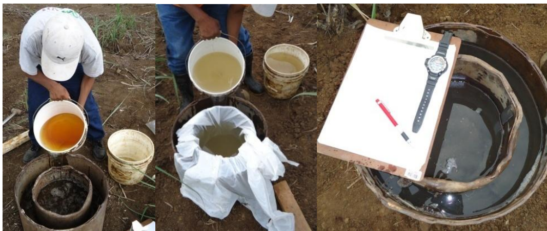
Figura 5. Colocación y aplicación de agua a los cilindros para determinar la infiltración básica del suelo
