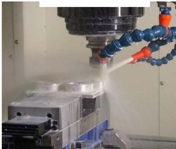
**Fig. 3.7** Centro de maquinado vertical, Bridgeport 2216
