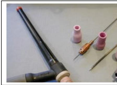
Fig. 2. Antorcha GTAW con varios electrodos, tazas, collares y difusores de gases
