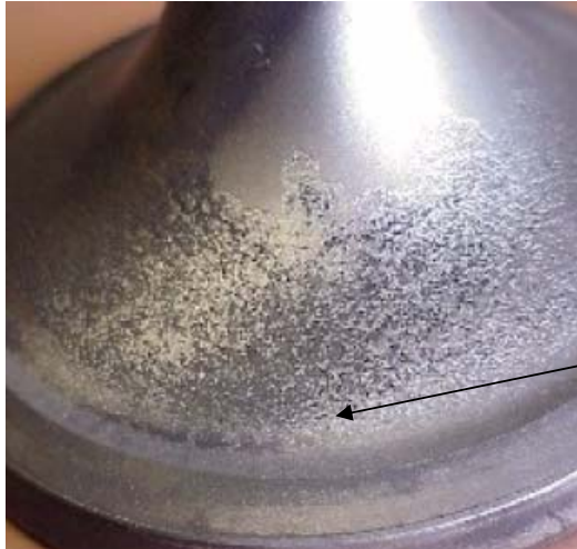
Corrosión en superficie de cono de válvula de admisión
