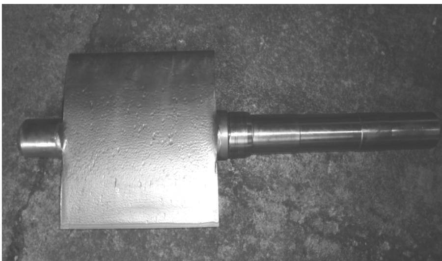
**Figura 18. Desgaste en la bandera del álabo (Fuente: Fotografía tomada en álabo directriz de la Central Hidroeléctrica los Esclavos).**
