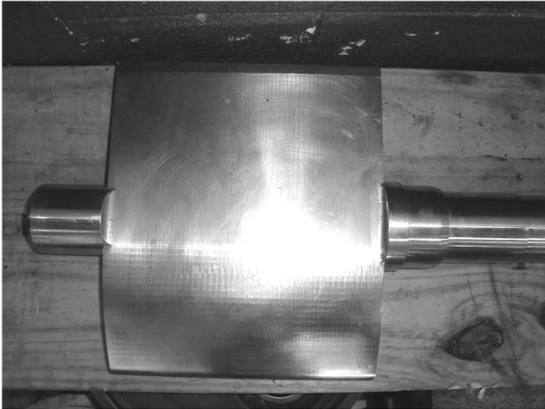
**Figura 22. Álabo nuevo (Fuente: Fotografía tomada en álabo directriz de la Central Hidroeléctrica los Esclavos)..**
