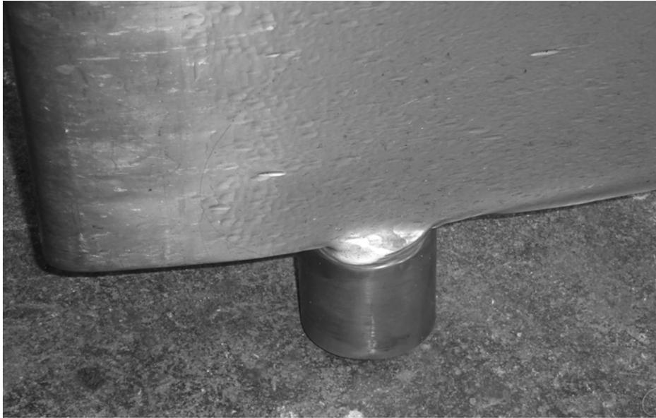
**Figura 19. Desgaste en la unión de la bandera con el eje inferior del álabe. (Fuente: Fotografía tomada en álabe directriz de la Central Hidroeléctrica los Esclavos).**
