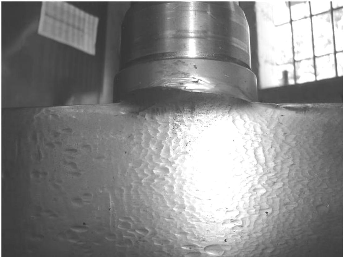
**Figura 20. Desgaste en la unión de la bandera con el eje superior del álabe. (Fuente: Fotografía tomada en álabe directriz de la Central Hidroeléctrica los Esclavos).**
