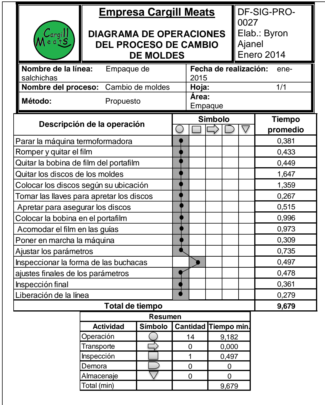
Figura 32. Diagrama de operación con método propuesto
