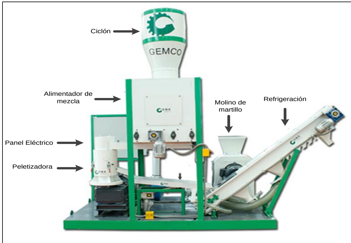
Figura 34. Planta propuesta para la producción de pellet
