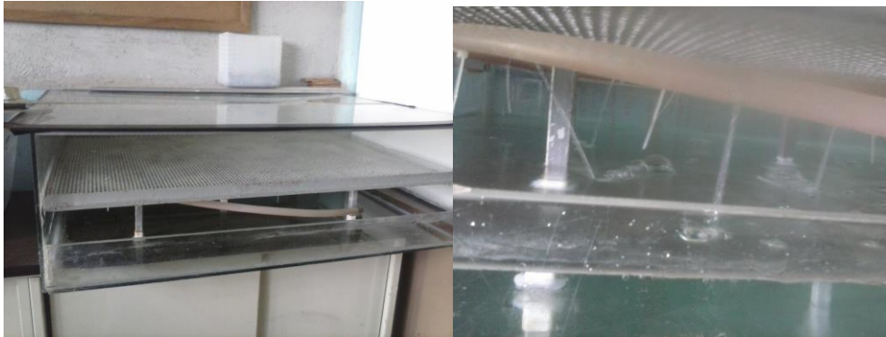
Figura 17. Cámara de Humedad
