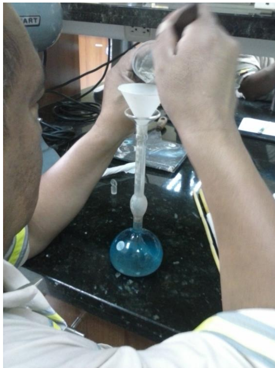
Figura 27. Cálculo de la densidad del cemento
