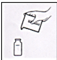
Figura 106. Vertido correcto de 25 ml de muestra frasco 1
