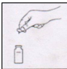
Figura 108. Vertido de sobre de ferover en muestra a analizar
