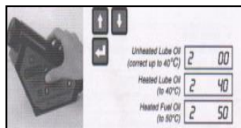
Figura 18. Utilización viscosímetro análisis de aceite
