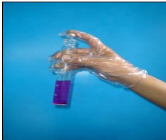
Figura 101. Forma correcta agitar probeta
