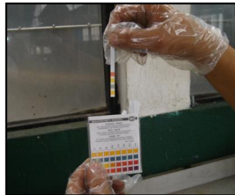
Figura 86. Forma correcta de tomar medidor de pH
