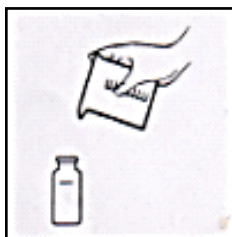
Figura 107. Vertido correcto de 25 ml de muestra frasco 2
