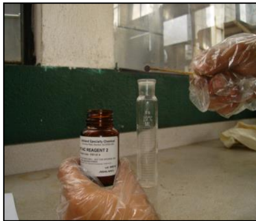
Figura 100. Forma correcta de añadir reactivo núm. 2
