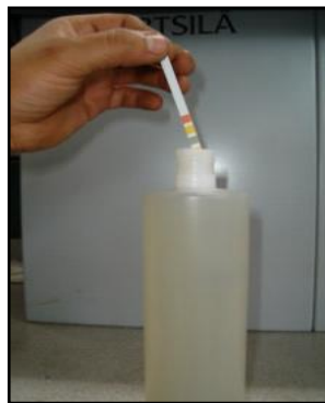
Figura 87. Forma correcta de insertar medidor de pH
