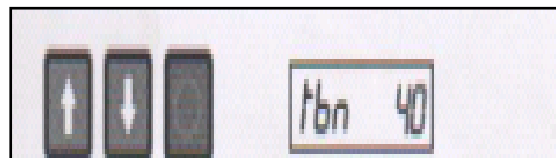
Figura 27. Forma de ingreso de valor de TBN de aceite nuevo
