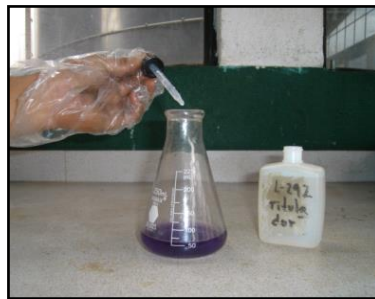
Figura 93. Vertido correcto de solución tituladora
