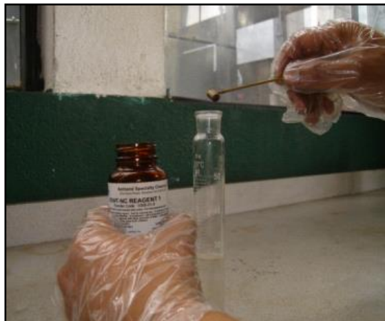
Figura 99. Forma correcta de añadir reactivo núm.1
