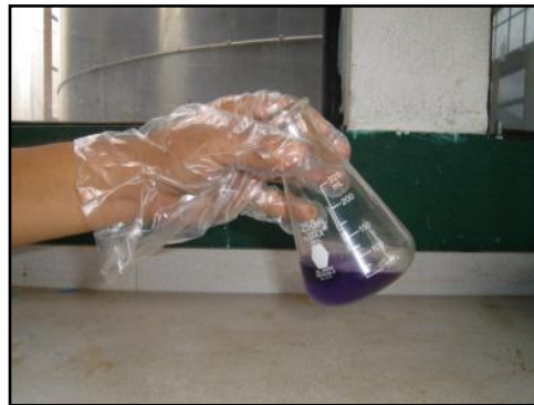
Figura 92. Agitación correcta para disolver químico
