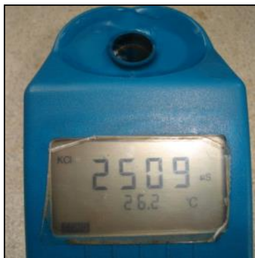
Figura 97. Obtención del resultado de conductividad
