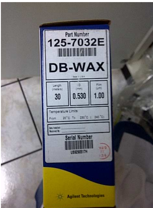
Figura 13. Empaque de la columna utilizada para la cromatografía
