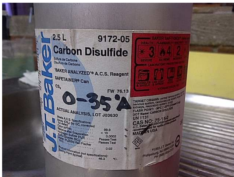
Figura 8. Sulfuro de carbono utilizado como desorbente
