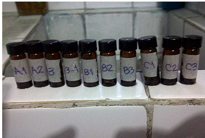
Figura 14. Tubos con muestras de carbón disueltas en sulfuro de carbono
