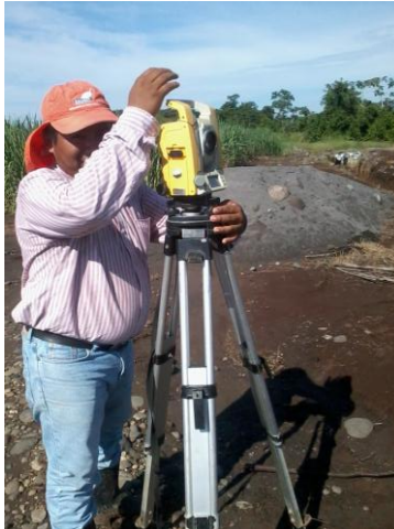
Figura 5: nivelación electrónica Fuente: Autor (2014)
