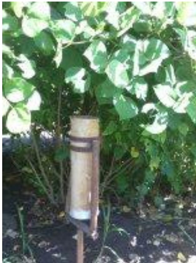
Figura 23: Pluviómetro mal ubicado Fuente: Autor (2014)
