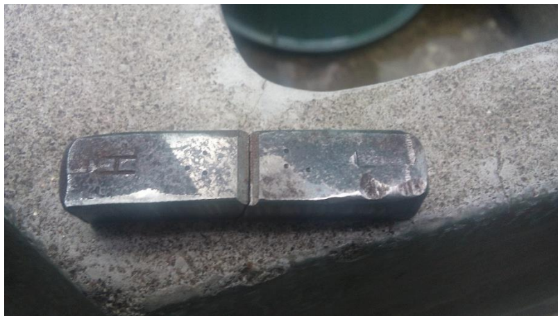
Figura 25. Imagen de la probeta después del corte oxiacetileno
