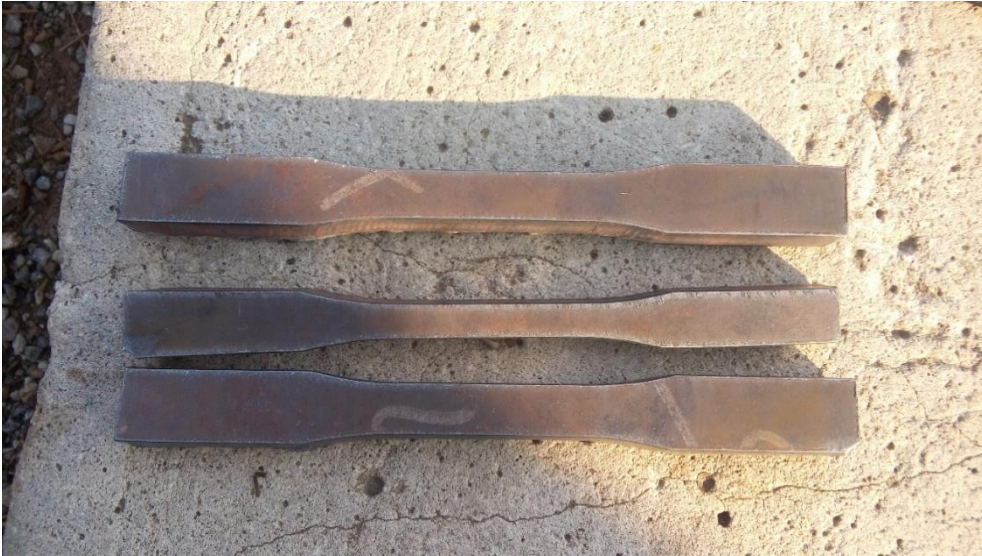
Figura 18. Imágenes de las probetas cortadas con oxiacetileno
