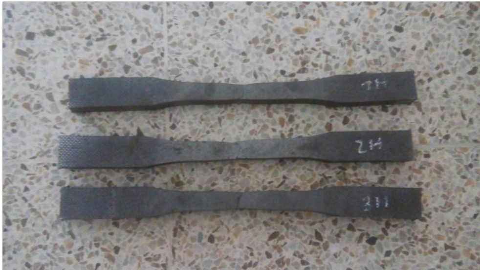
Figura 19. Imágenes de las probetas cortadas con corte abrasivo
