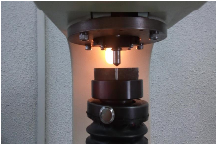
Figura 29. Imagen de la probeta y de la punta del diamante
