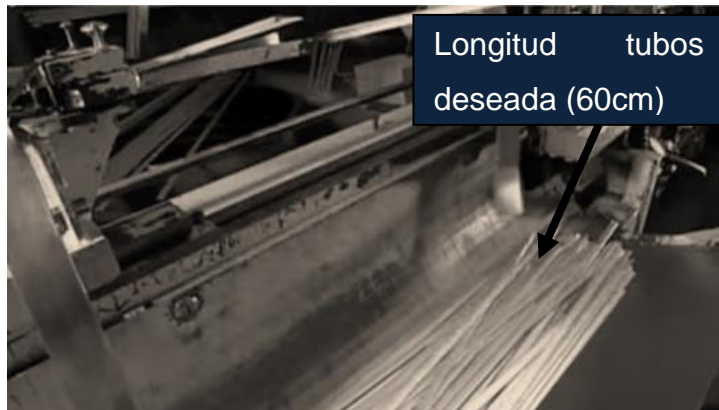
Figura 40. Corte de tubos a 60 cm
