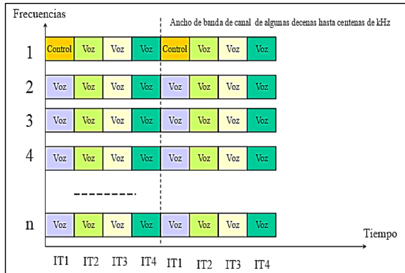
Figura 1. Estructura canal TDMA
