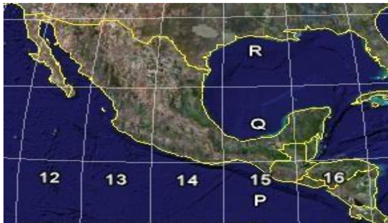
Figura 6. Zona UTM Guatemala
