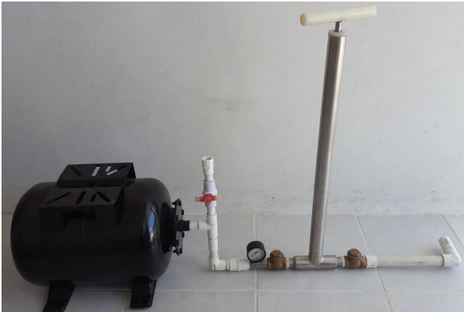
Figura 14. Equipo de bombeo manual con sistema hidroneumático
