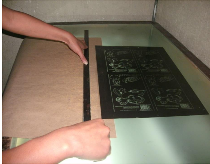
Figura 3. Proceso de alineación del negativo y medidas
