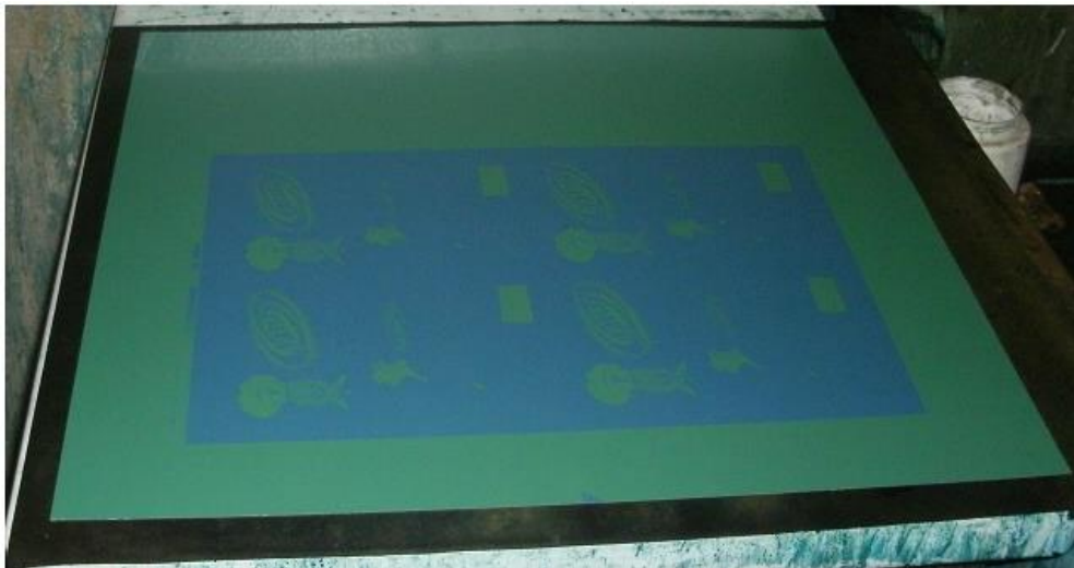
Figura 6. Placa en proceso de lavado
