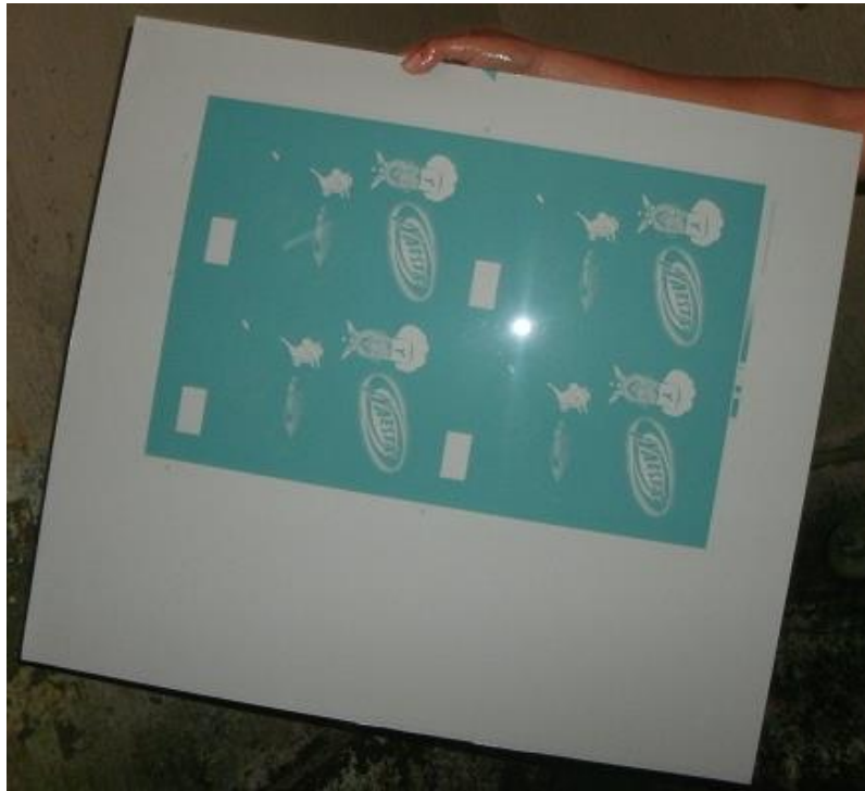
Figura 7. Placa terminada y lista para impresión offset
