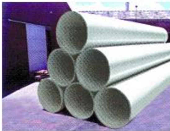
Figura 33. Almacenamiento de tubos tipo cama piramidal
