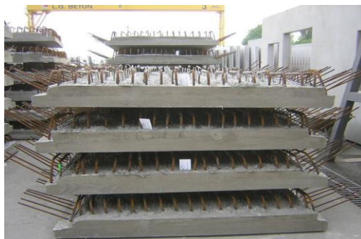
Figura 33. Losa de hormigón armado
