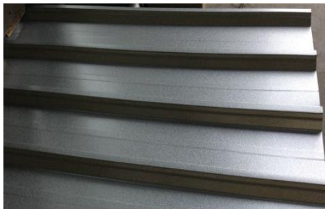
Figura 31. Lámina de aluzinc
