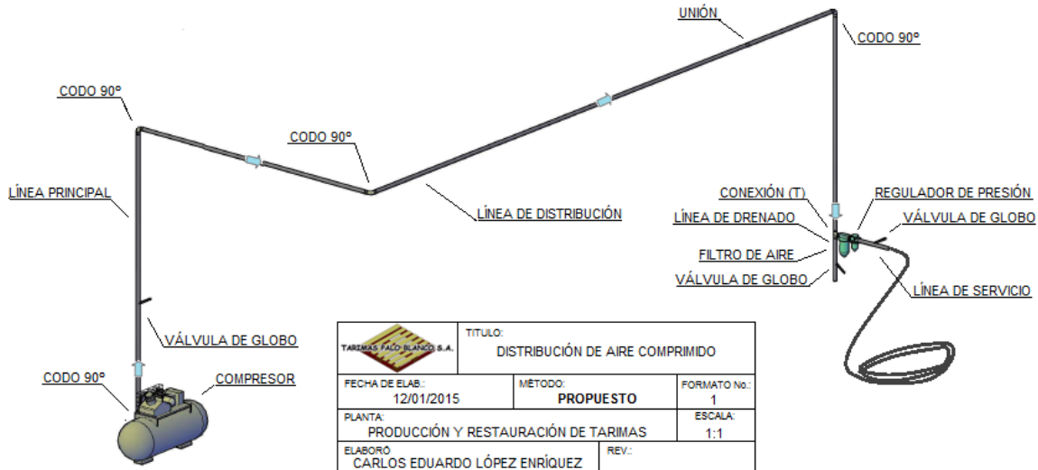
Figura 78. Distribución de aire comprimido
