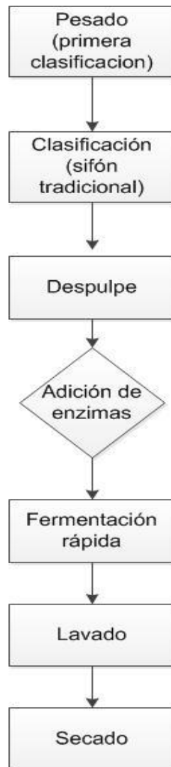
Figura 35. Diagrama de bloques beneficiado enzimático (fermentación rápida)
