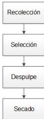
Figura 25. Etapas principales en el proceso de beneficiado húmedo de café
