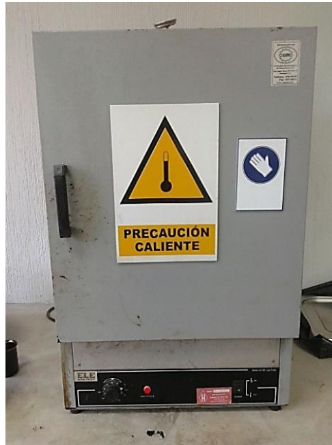
Figura 5. Equipo utilizado para calentar agregados al cemento asfáltico
