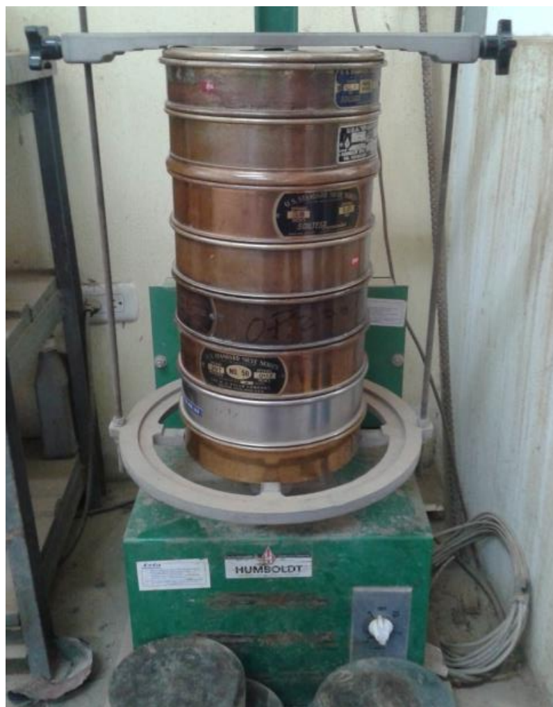
Apéndice 1. Juego de tamices utilizado para la separación por tamaño de las partículas del agregado pétreo
