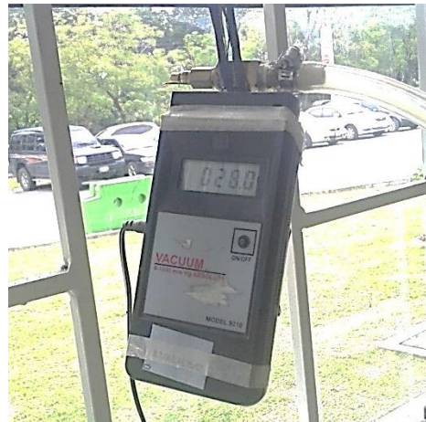
(b) Manómetro de presión residual
