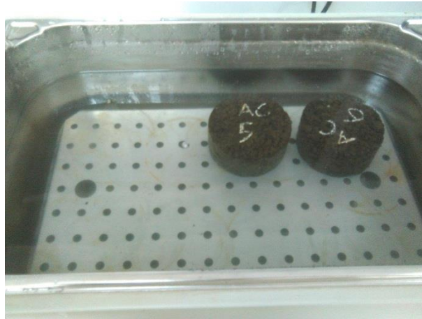
Figura 23. Tanque para agua controlado
