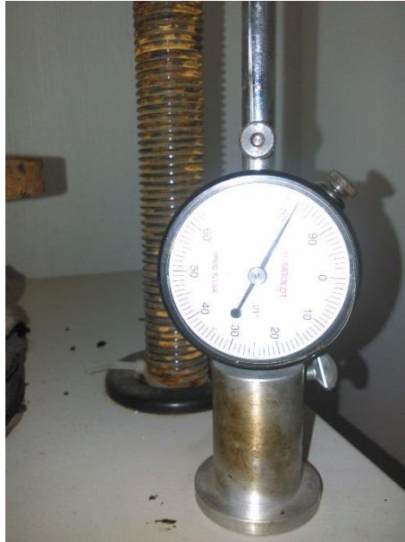
Figura 19. Medidor de deformación
